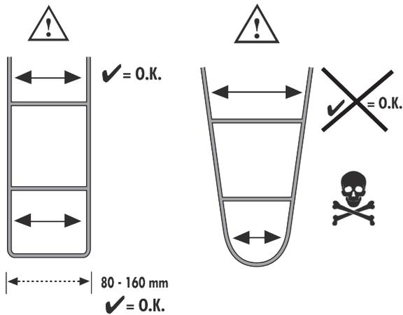
Adapateur Rack-Lock adapté aux porte-bagages qui présentent de surface d'appui rectangulaire et parallèle
